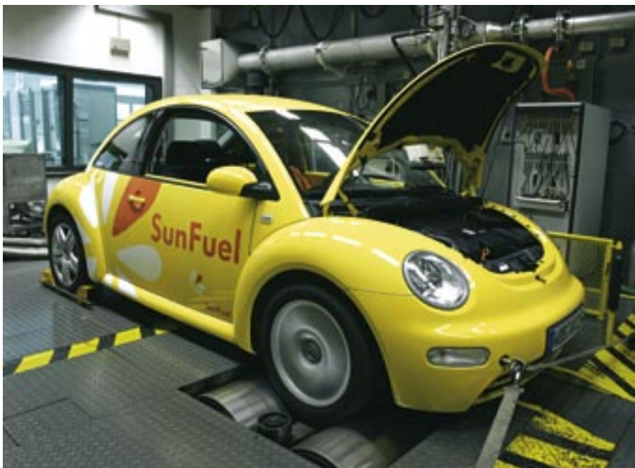
Gas geben für ein besseres Klima: New Beetle mit SunFuel zu Emissionsmessungen auf dem Rollenprüfstand
